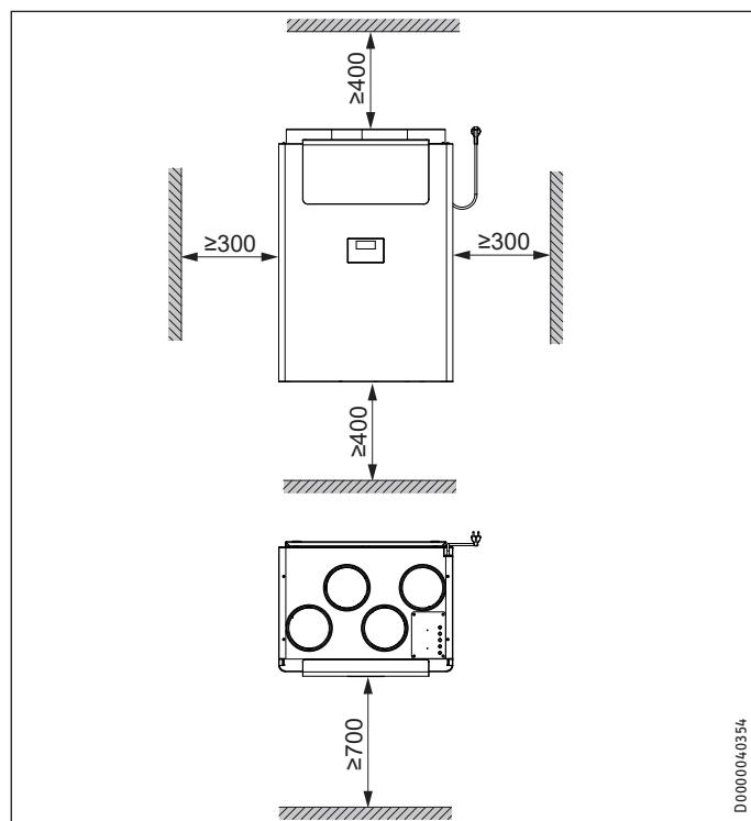
Schéma de mise en place avec coupole d'insonorisation
